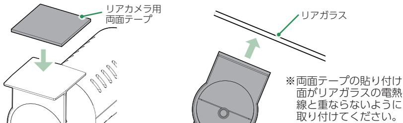
※両面テープの貼り付け面がリアガラスの電熱線と重ならないように取り付けてください。
