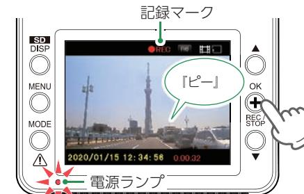
電源ランプが点灯、記録マークが「●REC」(赤)と表示され、録画を再開します。
