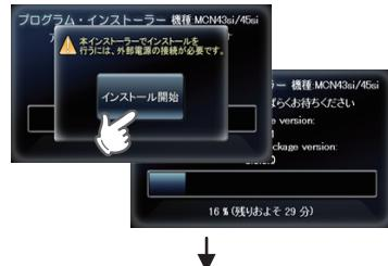
インストール完了後、右図画面になります。外部電源を外して電源をOFFにし、microSDカードを取り外してください。
