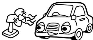
\*電動ファン搭載車…高速走行や真夏の走行後に、エンジンがある程度過熱していると、エンジン停止後も冷却のためにファンが回り続ける車種です。
