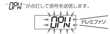
ジャンクションユニットが信号を認識すると、ドアをアンロックしてリモコンに信号を送り返します。
