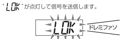
ジャンクションユニットが信号を認識すると、ドアをロックしてリモコンに信号を送り返します。
