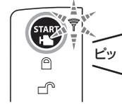
**2** アンテナマークが点滅中(約3秒間)に、「ドレミファン」が鳴るまでもう1度 **STOP**(アンロック)ボタンを押す
