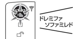
別売のハザード制御：A-18SFを接続していると、ハザードランプが3回点滅します。
