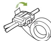
※ 接続された箇所（エレクトロタップ部）は、ショートや振動などにより、車両のスターター系にトラブルを起こす原因となることがあります。必ず絶縁テープでテーピングしてください。
