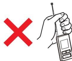
■ リモコンのアンテナは完全に引き出し、垂直に立てて操作してください。
