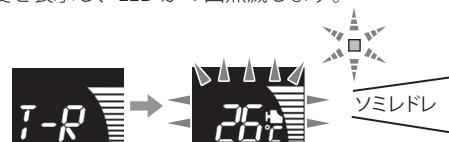
車室内温度は -30°C ~ 99°C の範囲を 1°C 单位で表示します。温度が -30°C 以下のときは -30°C、99°C 以上のときは 99°C で表示します。
