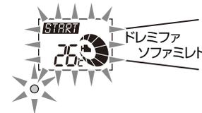
車室内温度は-30℃~99℃の範囲を1℃単位で表示します。温度が-30℃以下のときは-30℃、99℃以上のときは99℃で表示します。
