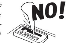
※一部の車両では、P・ポジション検出ができないものや、できにくいものがあります。このような場合には、フットブレーキまたはP・ポジションインジケータランプへの接続が必要です。接続しないと、本機は動作しません。フットブレーキに接続した場合は、フットブレーキを踏むとエンジンが停止します。またP・ポジションインジケータランプに接続した場合には、シフトレバーがパーキング（P）の位置以外ではエンジンを始動できません。
