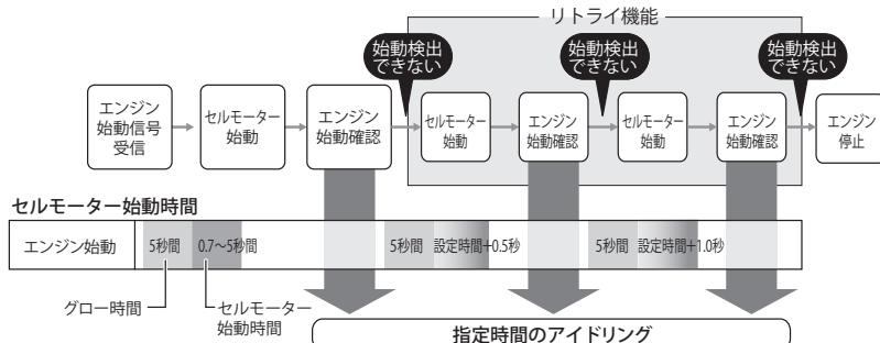
※ オルタネータ線を接続した場合、エンジンの始動を検出すると、セルモーターを停止します。
