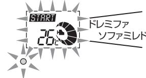
車室内温度表示設定(☞19ページ)をOFFにすると、車室内温度表示の替わりに「OK」を表示します。
