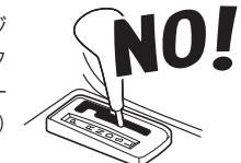
※一部の車両では、P・ポジション検出ができないものや、できにくいものがあります。このような場合には、フットブレーキまたはP・ポジションインジケータランプへの接続が必要です。接続しないと、本機は動作しません。フットブレーキに接続した場合は、フットブレーキを踏むとエンジンが停止します。またP・ポジションインジケータランプに接続した場合には、シフトレバーがパーキング（P）の位置以外ではエンジンを始動できません。
