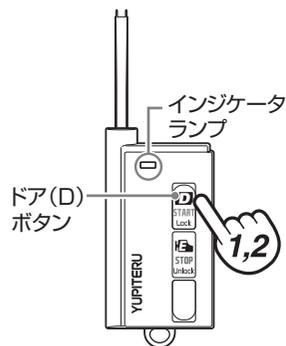
※別売ハザード制御：A-18SFを接続すると、ハザードランプを1回点滅させて、ドアがロックされたことをお知らせします。
