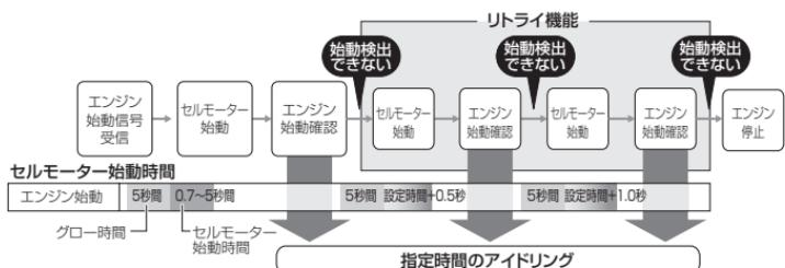
\* オルタネータ線を接続した場合、エンジンの始動を検出すると、セルモーターを停止します。
