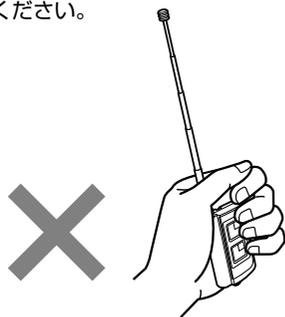
■リモコンのアンテナは完全に引き出し、垂直に立てて操作してください。
