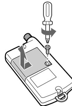
※ ネジ、部品の紛失に注意してください。また、ネジの大きさに合ったドライバーを使用してください。ネジのつぶれの原因となります。
