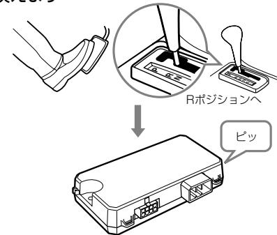
※ターボタイマー機能を使用する場合は、P・ポジションインジケーターランプにブレーキ検出線を接続のうえ、メインユニットのコネクター2にセンサーharnessを接続し、最初からP・ポジション自動検出を行ってください。
