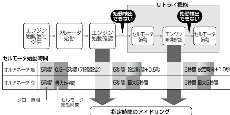
※ オルタネータ線を接続した場合、セルモータの始動時間は最大5秒となり、エンジンの始動を検出すると、セルモータを停止します。
