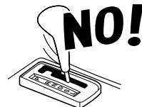
※一部の車輌では、P・ポジション自動検出のできないものや、できにくいものがあります。このような場合には、フットブレーキまたはP・ポジションインジケーターランプへの接続が必要です。接続しないと、本機は動作しません。フットブレーキに接続した場合は、フットブレーキを踏むとエンジンが停止します。またP・ポジションインジケーターランプに接続した場合には、シフトレバーがパーキング(P)の位置以外ではエンジンを始動できません。
