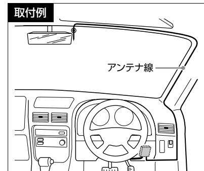
運転席窓が右図のように大きい車輌は、アンテナ線を最短距離に配線してください。
