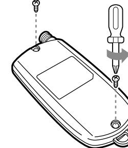
※ ネジ、部品の紛失に注意してください。また、ネジの大きさに合ったドライバーを使用してください。
