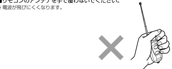
■リモコンのアンテナは完全に引き出し、垂直に立てて操作してください。
