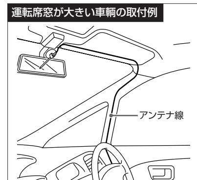
※アンテナ線は丸めたり、他の電源線や信号・グランド線と束ねたりせずに、すべての長さ(約2.4m)を使って、配線方法にしたがって取り付けてください。
