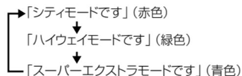
※ MACシステムがON(設定)のときに、受信感度セレクトボタンを押すと、ASS(最適感度選択)モードからスーパーエクストラモードとなります。再度押すと、ASSモードに戻ります。
