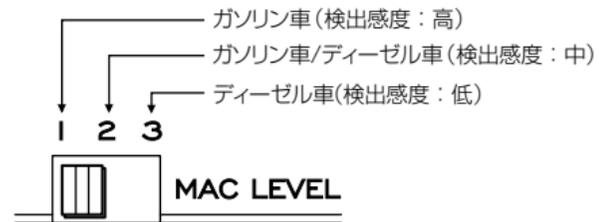
目安として、速度が約30km/hになるまでに、パイロットランプが緑色の点滅になる位置にしてください。
