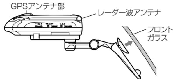
GPSアンテナ部の上やレーダー波アンテナの前に他の機器のアンテナや、金属などの障害物がこないように取り付けます。
