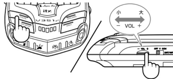
テスト&ミュートボタンを押す前から警報機能が働く場合は、近くで発信されている取締りレーダー波と同じ電波を受信しているためです。この状態でボタンを押すと、ミュート機能が働き、警報音が止まります。(32ページ参照)
