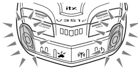
サーチが終わり、GPS測位機能が働くと、アラームランプは消灯します。初めての測位のときは、『ポーン 測位しました』とお知らせします。
