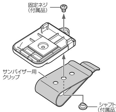
• サンバイザーに取り付けられない場合でも、固定ネジやシャフトはなくさないように、クリップやブラケットに付けた状態で保管してください。
