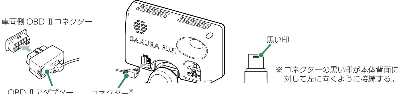
別売品の OBD II アダプターを本体の DC ジャックと車両の OBD II コネクターに接続してください。
