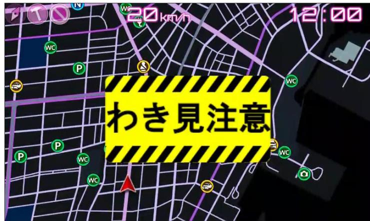
時速 10km/h 以上で運転中に約 3 秒以上わき見をしている場合に、警告します。
