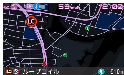
ループコイルなど「厳重注意」ターゲットを赤色のアイコンで警報。ターゲット名とターゲットまでの距離をカウントダウン表示します。
