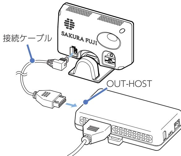
接続ケーブルをアダプターの [OUT-HOST] コネクターと、レーダー探知機の DC ジャックに接続します。
