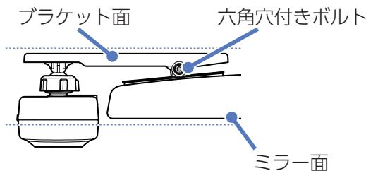
ルームミラーのミラー面と、ブラケットの面が平行になるように調整し、付属の六角レンチで六角穴付きボルトを締めて固定します。
