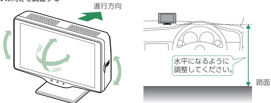
Gセンサーやジャイロセンサーが正しく動作するように、本体の背面が車両進行方向を向くようにし、画面が見やすいように調整してください。
