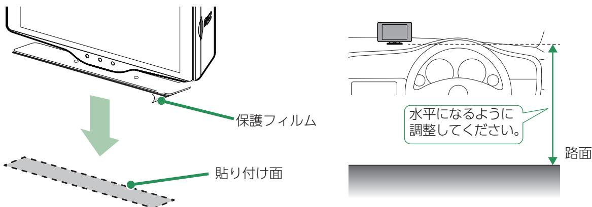
Gセンサーやジャイロセンサーが正しく動作するように、本体の背面が車両進行方向を向くようにし、画面が見やすいように調整してください。
