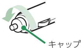
キャップを矢印の方向に回し、キャップを外します。
