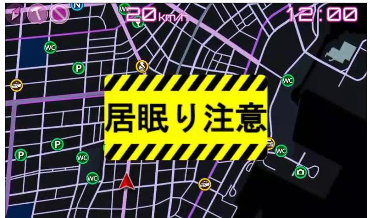
時速 10km/h 以上で運転中にまぶたを閉じている(両目を約 1 秒以上閉じている状態)場合に、警告します。
