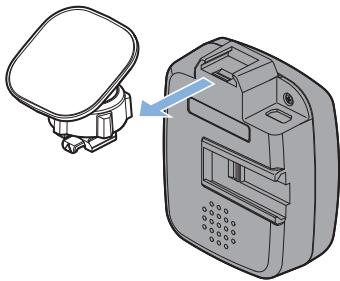
フロントガラス取り付け用ジョイントレールをスライドさせ取り付けます。
