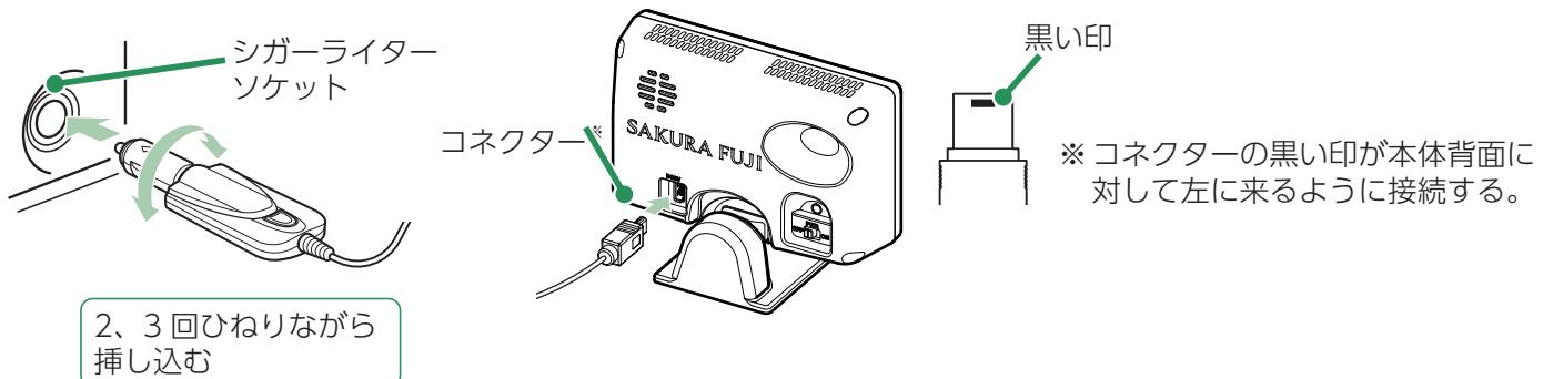
付属のシガープラグコードを本体のDCジャックと車両のシガーライターソケットに接続します。
