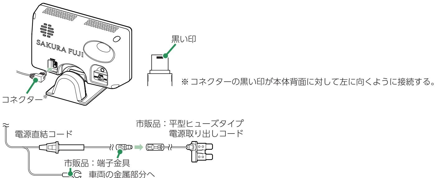
電源直結コードを本体の DC ジャックと市販品の平型ヒューズタイプ電源取り出しコードに接続します。
