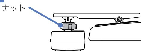
ナットを緩め、本機の向きを調整し、ナットを締めて固定します。
