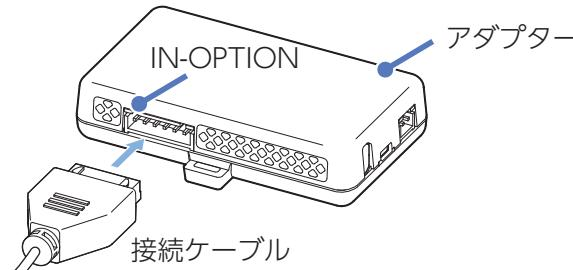
アダプターの [IN-OPTION] に接続ケーブルを接続します。
