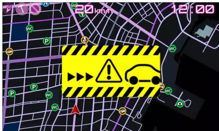
停止している先行車両に接近した場合に警告します。
