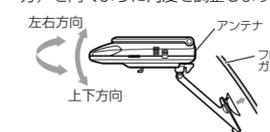
アンテナの前に他の機器のアンテナや金属、ゴムなどの障害物がこないように取り付けます。
