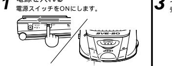
確認音(印) ピロッピッ... が数秒間鳴り、パワーバンドランプが点滅します。
