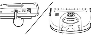
確認音(□□)ピロピロ□□…)が数秒間鳴り、パイロットランプが点滅します。
