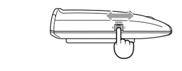
スーパー感度モードとカットダウンモードの切り換えができます。
