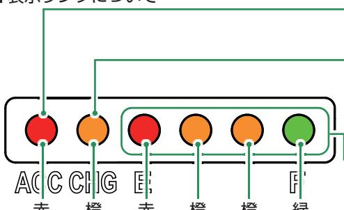
OP-MB4000に電源が供給されている時に点灯します。
