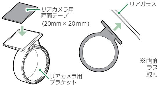
※両面テープの貼り付け面がリアガラスの電熱線と重ならないように取り付けてください。
