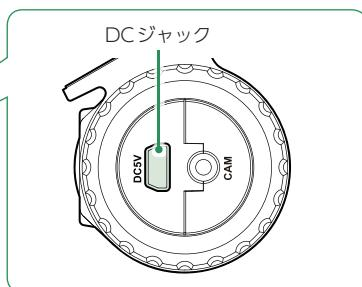
付属の電源直結コードをフロントカメラユニットのDCジャックへ接続します。
