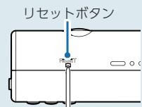
動作しなくなったり、誤作動を起こしたときは、フロントカメラユニット下部のリセットボタンを押して、システムを再起動させてください。
