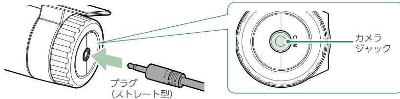
付属のリアカメラケーブルのプラグをリアカメラユニットのカメラジャックへ接続します。
