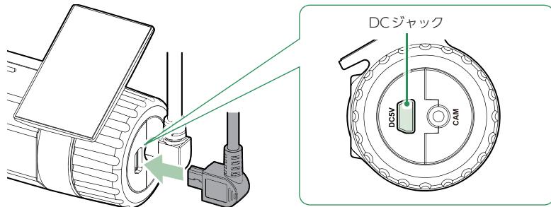
付属の電源直結コードをフロントカメラユニットのDCジャックへ接続します。
