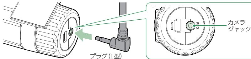
付属のリアカメラケーブルのプラグをフロントカメラユニットのカメラジャックへ接続します。
