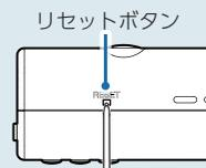
動作しなくなったり、誤作動を起こしたときは、フロントカメラユニット下部のリセットボタンを押して、システムを再起動させてください。
