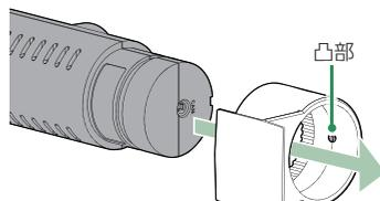
※ リアカメラ用ブラケットには凸部があり、無理に引き抜こうとすると破損の原因となります。必ず②の位置まで回してから取り外してください。
