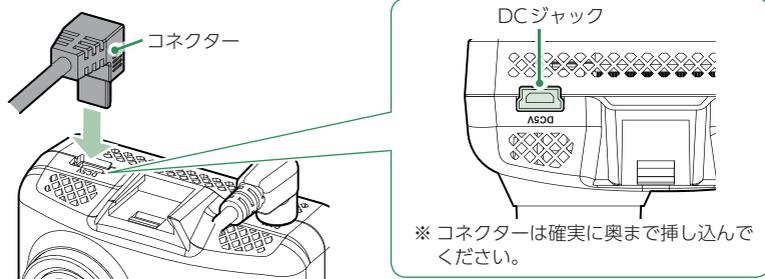
電源直結コードをフロントカメラユニットのDCジャックへ接続します。
