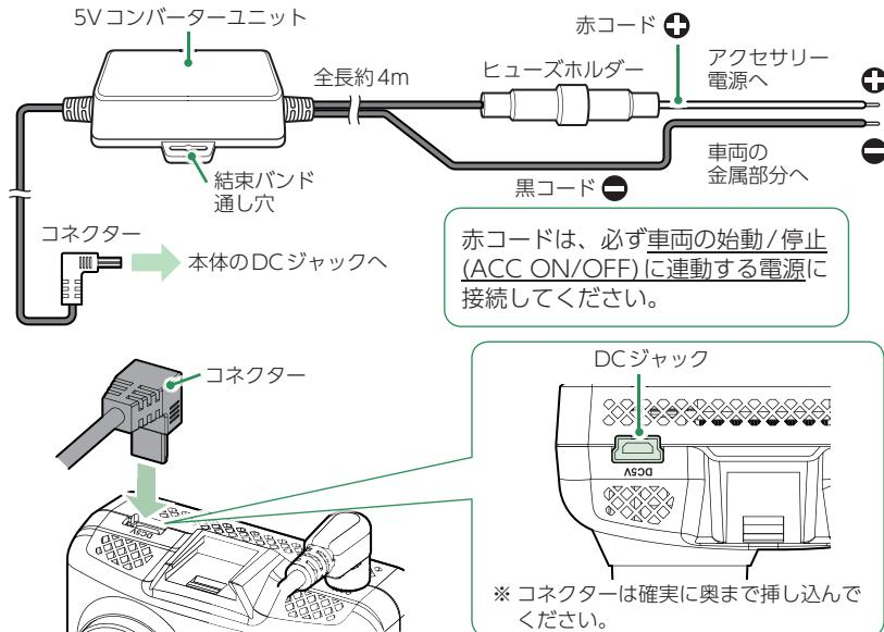
付属の電源直結コードをフロントカメラユニットのDCジャックと車両へ接続します。
