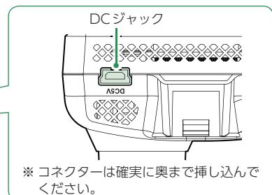
出力コードをフロントカメラユニットのDCジャックへ接続します。
