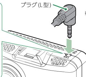
※ フロントカメラユニットにはプラグ(L型)をご使用ください。プラグ(ストレート型)を使用した場合、ケーブル接続時に負荷がかかり断線のおそれがあります。
