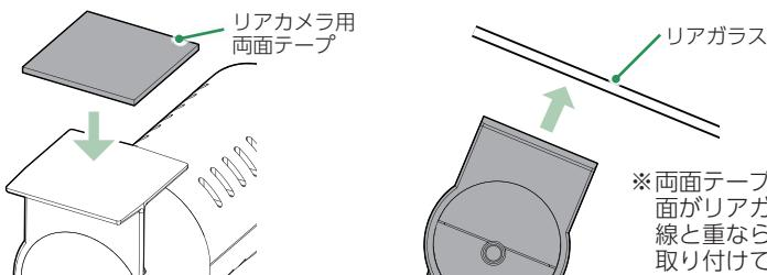
※両面テープの貼り付け面がリアガラスの電熱線と重ならないように取り付けてください。
