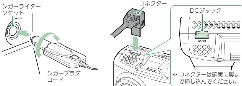
別売品のシガープラグコードをフロントカメラユニットのDCジャックと車両のシガーライターソケットに挿し込みます。
