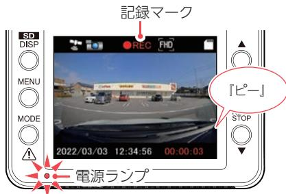
※ 付属品以外のSDカードを使用する場合、初回起動時に「SDカードを初期化してください」と表示します。数秒間無操作、またはOK(+)ボタンを押してメッセージ表示を解除するとSD初期化画面(③)を表示します。
