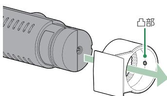
※ リアカメラ用ブラケットには凸部があり、無理に引き抜こうとすると破損の原因となります。必ず②の位置まで回してから取り外してください。
