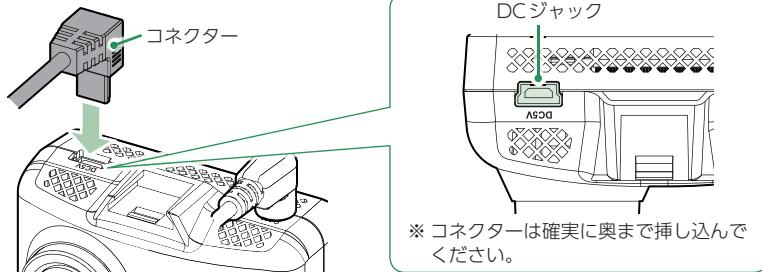
付属の電源直結コードをフロントカメラユニットのDCジャックへ接続します。
