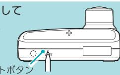
動作しなくなったり、誤作動を起こしたときは、本体下部のリセットボタンを押して、システムを再起動させてください。
