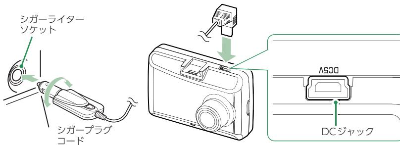
付属のシガープラグコードを本体のDCジャックと車両のシガーライターソケットに差し込みます。
