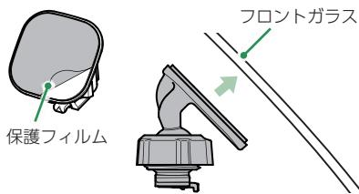
ブラケットに本体を装着したときに、電源コードが接続でき、ボタン操作がしやすい場所に取り付けてください。
