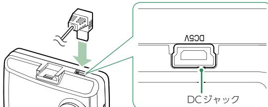
別売品の電源直結コード(OP-E863)を本体のDCジャックへ接続します。
