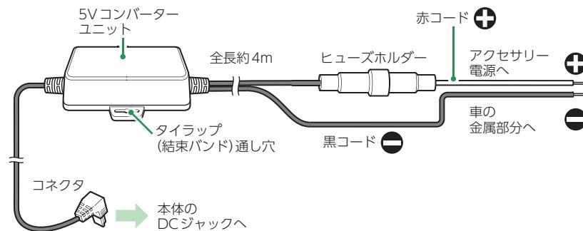
別売品の電源直結コードを本体のDCジャックと車両へ接続します。
