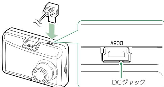
別売品の電源直結コード(OP-E863)を本体のDCジャックへ接続します。
