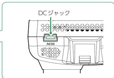
付属のシガープラグコードを本体のDCジャックと車両のシガーライターソケットに挿し込みます。
