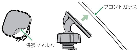
ブラケットに本体を装着したときに、電源コードが接続でき、ボタン操作がしやすい場所に取り付けてください。
