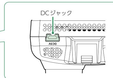
別売品の電源直結コードを本体のDCジャックと車両へ接続します。
