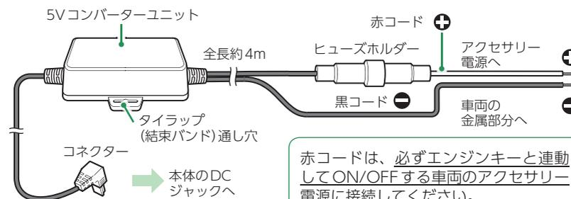
赤コードは、必ずエンジンキーと連動してON/OFFする車両のアクセサリ電源に接続してください。
