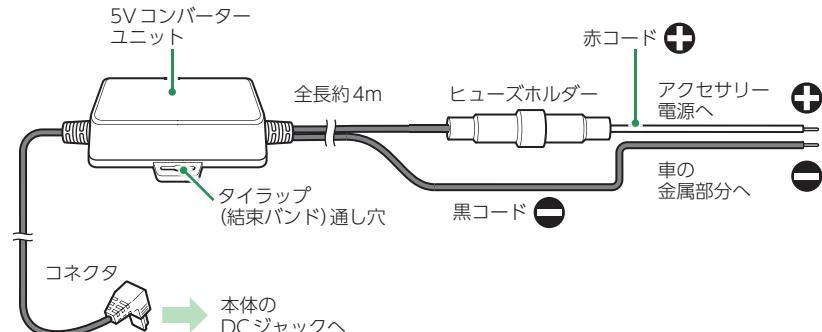
付属の電源直結コードを本体のDCジャックと車両へ接続します。
