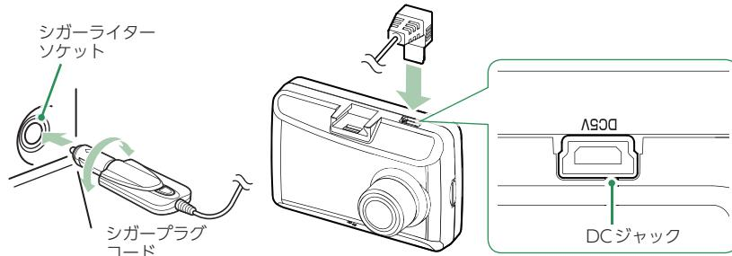
付属のシガープラグコードを本体のDCジャックと車両のシガーライターソケットに差し込みます。
