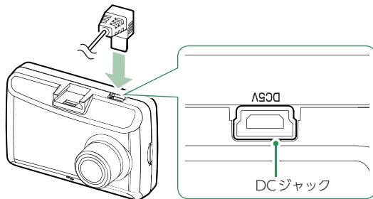
付属の電源直結コード、または別売品の電源直結コード(OP-E863)を本体のDCジャックへ接続します。
