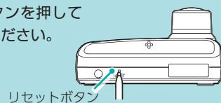
動作しなくなったり、誤作動を起こしたときは、本体下部のリセットボタンを押して、システムを再起動させてください。
