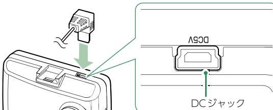
付属の電源直結コード、または別売品の電源直結コード(OP-E863)を本体のDCジャックへ接続します。
