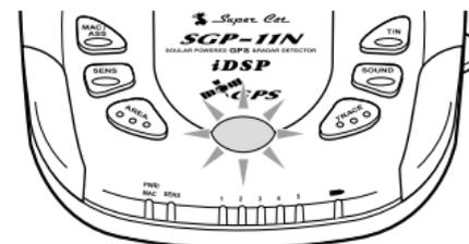
サーチが終わり、GPS測位機能が働くと、GPS警告ランプは消灯します。
