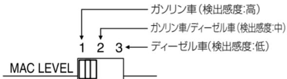
目安として、速度が約30km/hになるまでに、パイロットランプが緑色の点滅になる位置にしてください。
