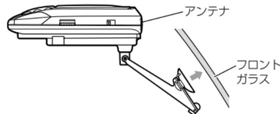
アンテナの前に他の機器のアンテナや金属、ゴムなどの障害物がこないように取り付けます。
