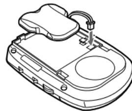
本機はソーラー電卓などと違い、ソーラーバッテリーのみでの駆動はできません。専用の充電電池を接続して、初めて動作しますので、必ず接続してください。ソーラーバッテリーは専用の充電電池を補充するためのものです。
