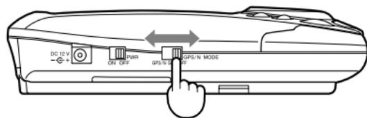
GPSまたはGPS/Nに切り換えると、GPSの電波をサーチしはじめ、アラームランプが青色に点滅します。
