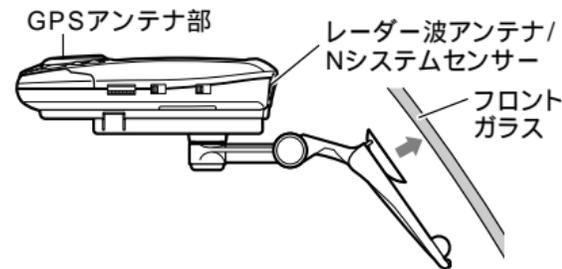
GPSアンテナ部の上やレーダー波アンテナ/Nシステムセンサーの前に他の機器のアンテナや、金属などの障害物がこないように取り付けます。
