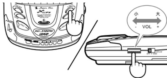
テスト&ミュートボタンを押す前から警報機能が働く場合は、近くで発信されている取締りレーダー波と同じ電波を受信しているためです。この状態でボタンを押すと、ミュート機能が働き、警報音が止まります。(28ページ参照)
