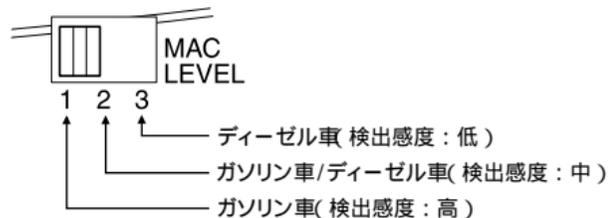
目安として、速度が約30km/hになるまでに、パイロットランプが緑色の点滅になる位置にしてください。
