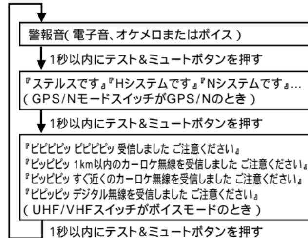
シガープラグコードを接続しているとき、およびGPS告知モード時は、『ステルスです』『Hシステムです』の音声だけになり、『Nシステムです』の音声はなくなります。(51、53ページ参照)
