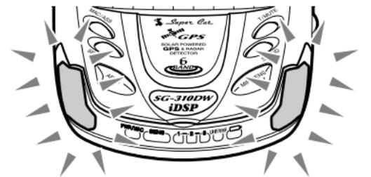
サーチが終わり、GPS測位機能が働くと、アラームランプは消灯します。初めての測位のときは、『ポーン 測位しました』とお知らせします。
