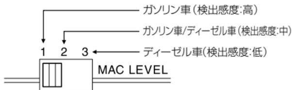
目安として、速度が約30km/hになるまでに、パイロットランプが緑色の点滅になる位置にしてください。MACの働きによりパイロットランプが赤色に点滅中は警報しません。(取締りレーダー波を受信しません)
