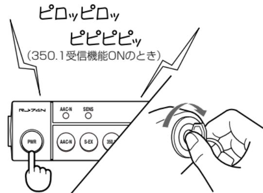
ユニット間の伝送が正常に行われていると、確認音が数秒間鳴り(パワー・オン・ビーブ)、スーパーキャットランプとシグナルメーターの[1]が点灯します。(27ページ)
