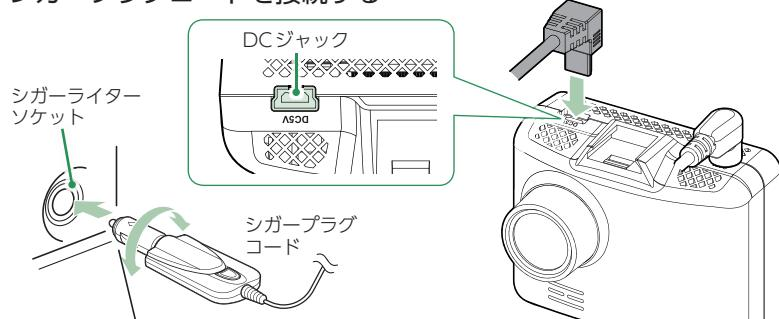
付属のシガープラグコードをフロントカメラユニットのDCジャックと車両のシガーライターソケットに差し込みます。
