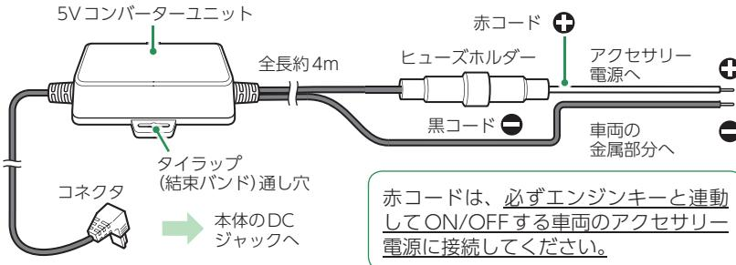
別売品の電源直結コードをフロントカメラユニットのDCジャックと車両へ接続します。
