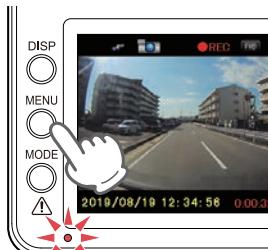
MENUボタンを押すたびに、音声録音のON/OFFが変更できます。
