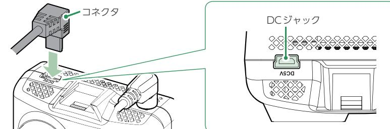
別売品の電源直結コード(OP-E1125)を本体のDCジャックへ接続します。
