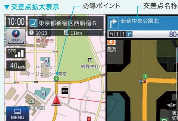
次に曲がるべき交差点の拡大イラストを表示。また、交差点名や、その交差点までの距離、進入時の走行レーンなども表示します。
