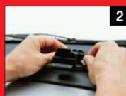
2 サイドの角度調節用ナットでクレードルの角度を決めて固定します。
