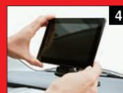
4 ナビ本体の取付け突起部に合わせてセットし、「カチッ」と音がするまで差し込みます。
