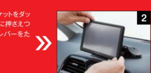
2 本体の溝をブラケットのレールに合わせてセットし、「カチッ」と音がするまで押し込みます。
