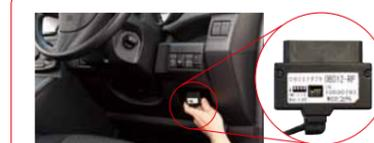
OBDIIアダプターを車内の専用コネクタに差込むだけ。
