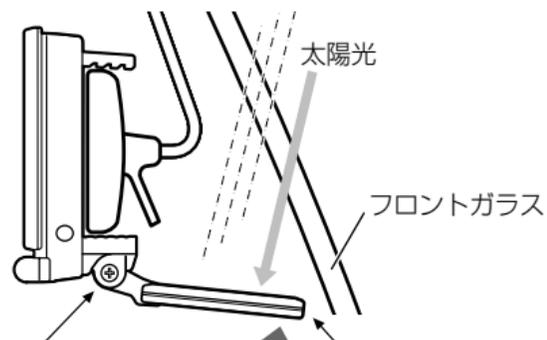
ソーラープレートの動きがきついときやゆるいときは接合部のネジをドライバーで調整してください。
