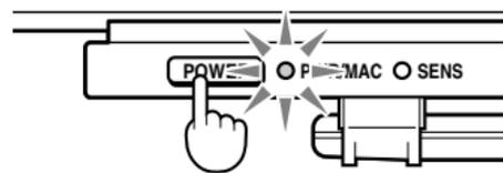
ターン・オン・ビーブ(🔊)ピロップピロツ…が鳴り、パイロットランプが点滅します。
