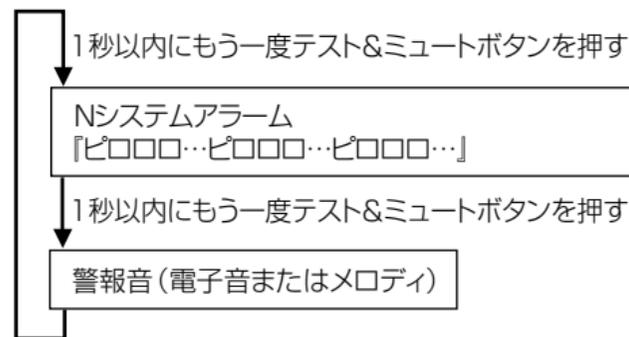
テスト&ミュートボタンを押す前から警報機能が働く場合は、近くで発信されている取締りレーダー波と同じ電波を受信しているためです。この状態でボタンを押すと、ミュート機能が働き、警報音が止まります。(26ページ参照)
