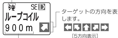
ターゲットまでの距離を表し、近づくにしたいがカウントダウンします。
