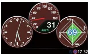
●配置 2 で表示される中メーターは以下の種類が設定可能です。現在設定されているカテゴリ、種類のボタンが青く選択されています。OBID II アダプターで接続していない場合、および対応していない項目は、ボタンが押せません。カテゴリ内の項目がすべて非対応の場合は、カテゴリボタンが押せません。バックライトの「ON / AUTO / OFF」、バックライト色、半透過モード「ON / OFF」、付加情報表示「ON / OFF」が選択できます。付加情報は停車時、しばらくすると表示されます。
