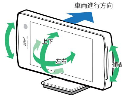
**7** 本機が正しく動作するように、本機の背面が車両進行方向を向くようにし、画面が見やすいように調整してください。
