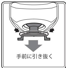
アーム部のツバの部分の布などを布などで保護し、手前に引き抜きます。ラジオペンチなどを使用すると、簡単に抜けます。爪部を掴むと爪が折れる場合があります。
