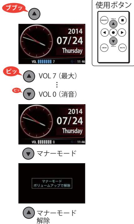
[▲]、[▼]ボタンで音量を調整できます。『ビッ』という確認音で音量を確認してください。
