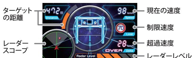
●警報表示設定が「OFF」の場合(☞48ページ)は、ターゲット表示エリアにターゲットの種類と距離を文字で表示します。
