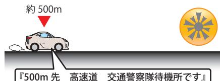
※GPSの受信状況やGセンサー/ジャイロセンサーの動作状況により、距離の告知『500m先』が『300m先/200m先/100m先/すぐ先』になる場合があります。
