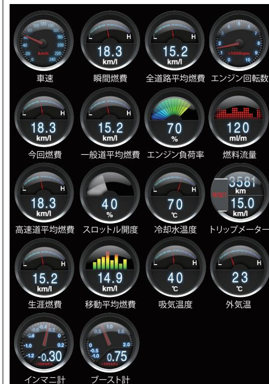
初期設定では、マルチメーターには「瞬間燃費」、「全道路平均燃費」、「トリップメーター」が表示されています。これを左図の18種類のメーターの中から選択し、表示を変更することができます。
