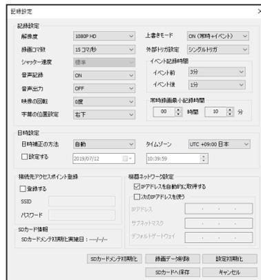
設定変更を行う場合は必ず SD カードをリーダライターに挿入してご使用ください。「SD カードへ保存」をクリックすると設定内容が SD カードに保存されます。SD カードを本体に装着し、本体を電源 ON すると設定内容が反映されます。
