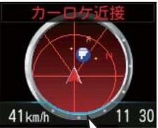
「無線自動車動態表示システム」のことで、警察の通信司令本部がパトカーなどの移動局の現在位置をリアルタイムで地図上に表示し、把握するためのシステムです。カーロケーターシステムを搭載した移動局は、GPSによる緯度・経度情報をデジタル化し、それを407.7MHz帯の周波数でデータ伝送しています。本機は、それを受信することにより、移動局が近くにいることを警報します。
