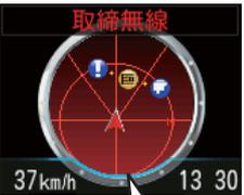
スピード違反やシートベルト着用義務違反の取締現場では、350.1MHzの電波で無線連絡が行われることがあります。これが取締り無線です。本機は、それを受信することにより、近くで取締りが行われていることを警報します。
