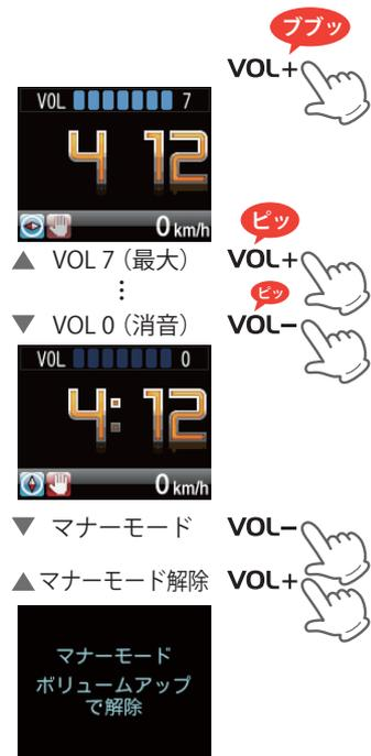
[VOL+]、[VOL-]ボタンで音量を調整できます。『ピッ』という確認音で音量を確認してください。
