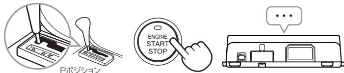
**2** ブレーキペダルを踏み込み、確認音『ピッ』が鳴るか確認する
