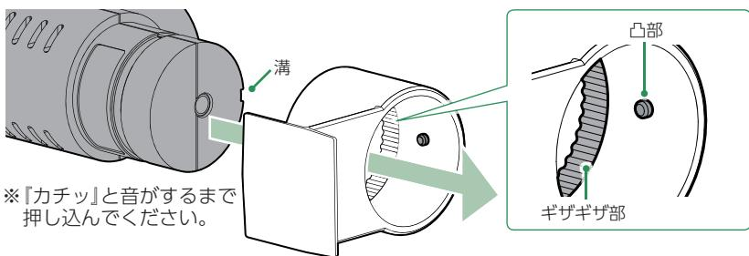
上図のようにリアカメラユニットの溝とリアカメラ用ブラケットの凸部を合わせ、ブラケットのギザギザ部が内側になるように装着してください。
