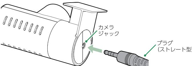
付属のリアカメラケーブルのプラグをリアカメラユニットのカメラジャックへ接続します。
