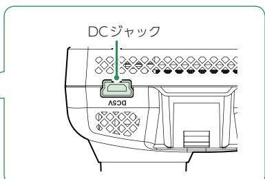
付属の電源直結コードを本体のDCジャックへ接続します。
