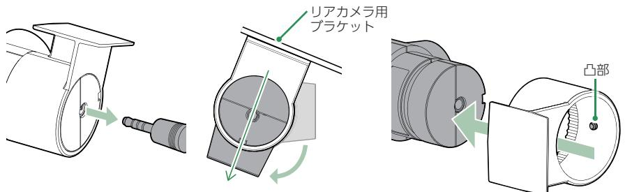
※リアカメラ用ブラケットには凸部があり、無理に引き抜こうとうすると破損の原因となります。必ず②の位置まで回してから取り外してください。
