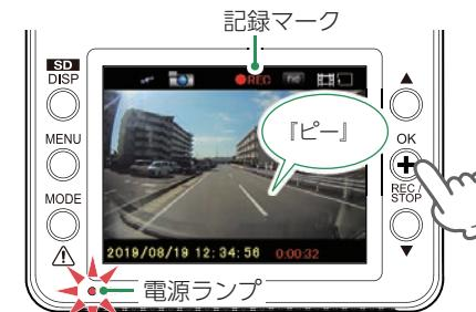
電源ランプが点灯、記録マークが「●REC」(赤)と表示され、録画を再開します。
