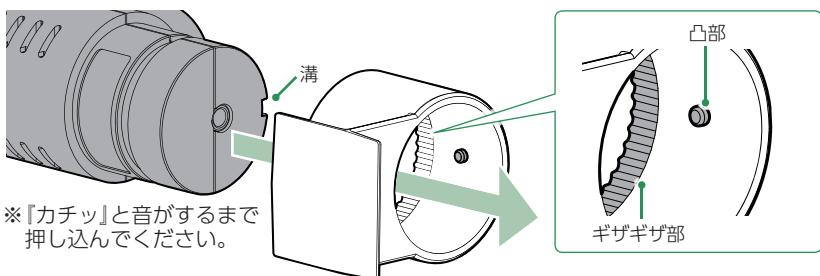
上図のようにリアカメラユニットの溝とリアカメラ用ブラケットの凸部を合わせ、ブラケットのギザギザ部が内側になるように装着してください。
