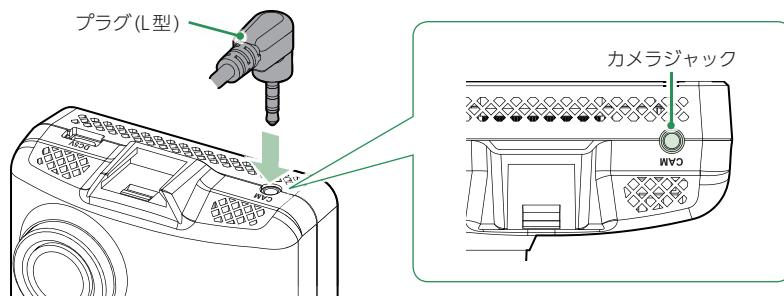
付属のリアカメラケーブルのプラグをフロントカメラユニットのカメラジャックへ接続します。
