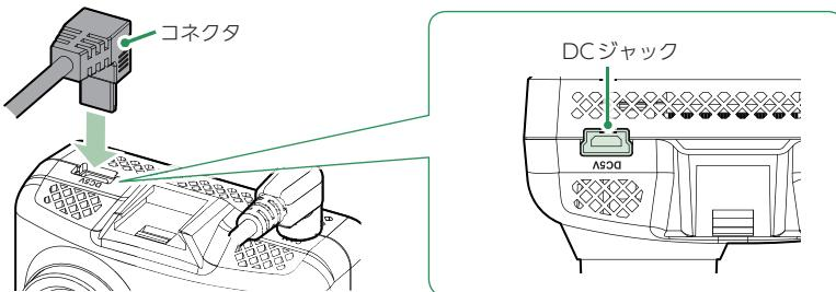
付属の電源直結コードをフロントカメラユニットのDCジャックと車両へ接続します。
