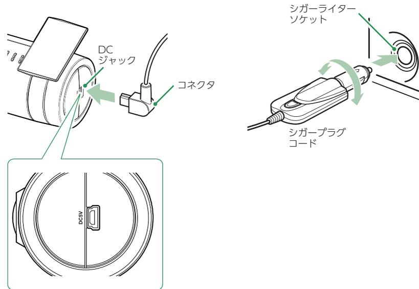
付属のシガープラグコードを本体のDCジャックと車両のシガーライターソケットに差し込みます。
