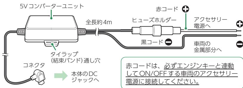
別売品の電源直結コード(OP-E1060)を本体のDCジャックと車両へ接続します。
