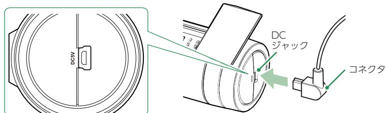
別売品の電源直結コード(OP-E1060)を本体のDCジャックへ接続します。
