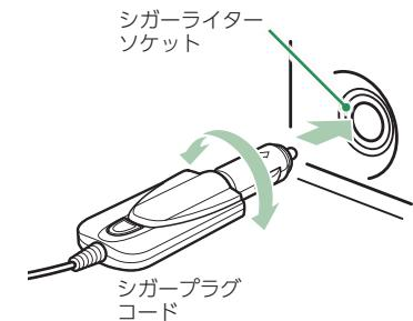
付属のシガープラグコードを本体のDCジャックと車両のシガーライター ソケットに差し込みます。
