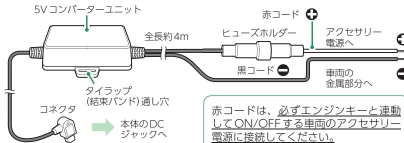
別売品の電源直結コード (OP-E1060) を本体のDCジャックと車両へ接続します。
