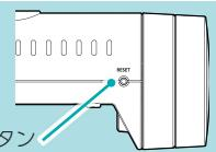
動作しなくなったり、誤作動を起こしたときは、本体下部のリセットボタンを押して、システムを再起動させてください。
