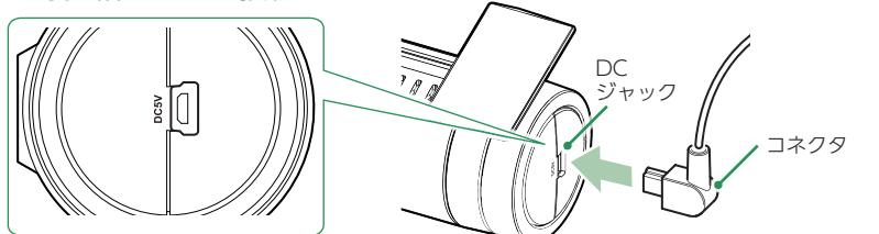
別売品の電源直結コード(OP-E1060)を本体のDCジャックへ接続します。
