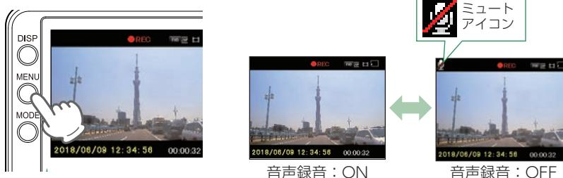
MENUボタンを押すたびに、音声録音のON/OFFが変更できます。
